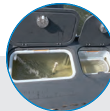
Vivier électrique oxygéné de 61 L/16 gal. U.S. à l'arrière
