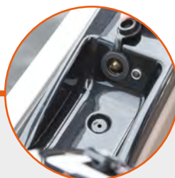
PRISE ÉLECTRIQUE 12 volts sur la console conducteur
