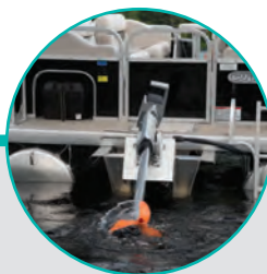
SYSTÈME DE RÉGLAGE d'assiette et de basculement assisté (pour moteur Torqeedo)
