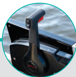
CONTRÔLE DU MOTEUR fixé au côté du ponton
