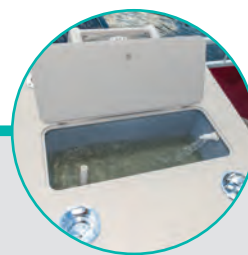
VIVIER ÉLECTRIQUE oxygéné de 39 L à l'arrière
