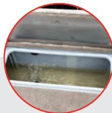
Vivier avant SportFlo MD de 77 L (20 gal. U.S.) incluant rebord anti- éclaboussures, trop- plein et filtre protecteur sur la pompe de remplissage
