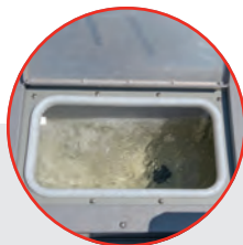
Vivier avant SportFlo MD de 61 L (16 gal. U.S.) avec système d'oxygénation (offert en option sur Yukon 140 BT)
