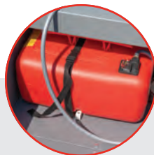
Espace de rangement pour le réservoir d'essence portatif
