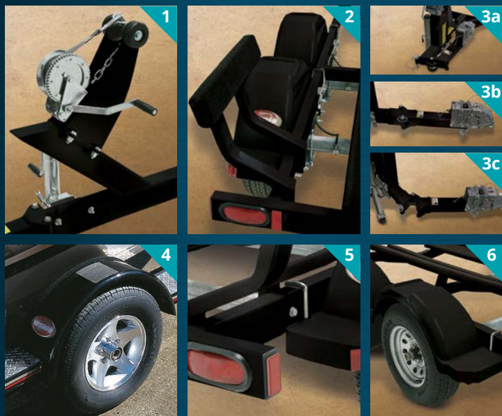
/1. Treuil robuste* /2. Guides d'alignement recouverts de tapis marin* /3. Pôle pliante* /4. Jantes en alliage optionnelles* /5. Système d'éclairage étanche DEL* /6. Ailes en composite avec marchepieds*
