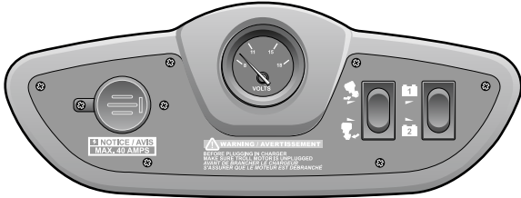
FIGURE 4-4 LA PRISE 12/24 VOLTS DU MOTEUR ÉLECTRIQUE
