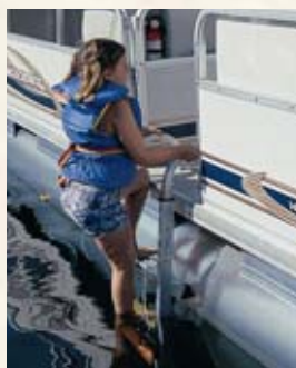
Échelle d'embarquement latérale repliable de quatre marches
