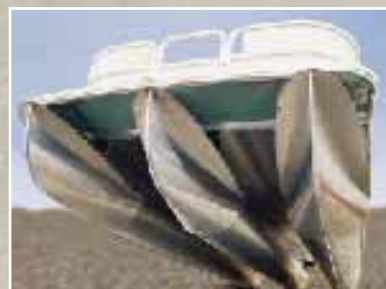
Ensemble de performance Cet ensemble comprend un flotteur central et un panneau anti-éclaboussures en aluminium. Ce flotteur supplémentaire augmente la capacité de chargement et la performance, tandis que le panneau anti-éclaboussures réduit la friction des vagues, ce qui garantit un fonctionnement plus doux à haute vitesse.
