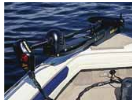
Option Ce support de moteur recouvert de tapis permet de fixer solidement le moteur électrique et le maintient fermement en place lorsque vous vous déplacez sur l'eau ou sur la route.
