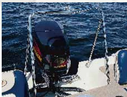
Option Ce mât de remorquage optionnel maintient le câble de remorque à la bonne hauteur et dans le bon angle. Vous pouvez l'enlever lorsque les skieurs ne l'utilisent pas.
