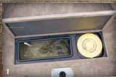
1. Vivier avant ProFlo MD de 77 L avec système de remplissage électrique et d'oxygénation, minuterie, recirculation, trop-plein, déversement à l'extérieur, seau à ménés amovible, lumière et rebord anti-éclaboussures
