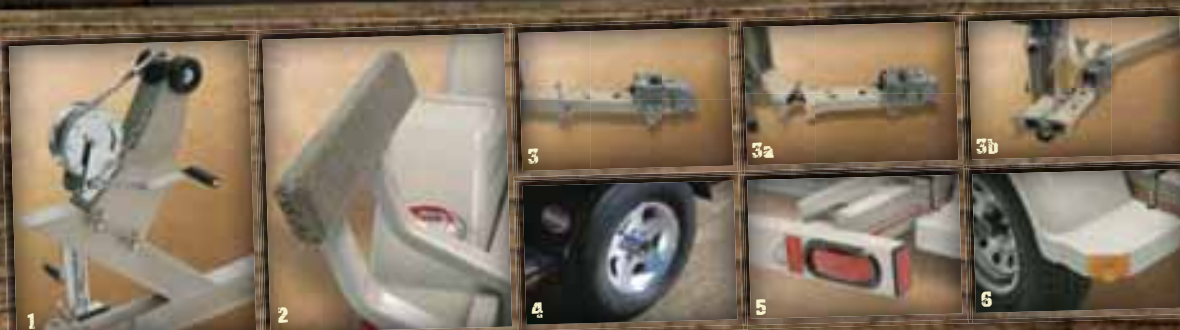
1. Treuil robuste* 2. Guides d'alignement recouverts de tapis marin* 3. Pôle pliante* 4. Jante en alliage optionnelle* 5. Système d'éclairage étanche* 6. Ailes en composite avec marchepieds*
